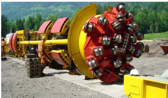
Ausbruch des Schrägschachtes mit Tunnelbohrmaschine (TBM Typ Wirth \varnothing 3.00 m mit Rückfallsicherung)
