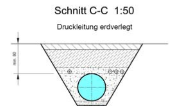
Erdverlegte Druckleitung im Fellboden (D = 0.9 m)
