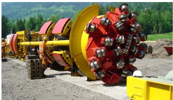
Excavation du puits incliné avec le tunnelier (Tunnelier Type Wirth \varnothing 3.00 m)
