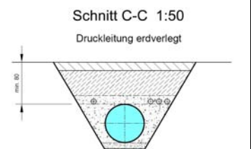
Section conduite forcée enterrée à Fellboden (D = 0.9 m)
