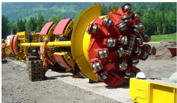
Scavo del pozzo inclinato con fresa (TBM tipo Wirth \varnothing 3.00 m con sicurezza per l'arretramento)
